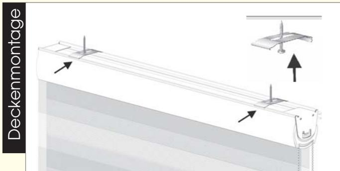
Die Clipse werden mithilfe der im Lieferumfang enthaltenen Dübel an der Decke befestigt und das Duo-Rollo mit dem Profil in die Clipse eingerastet.
