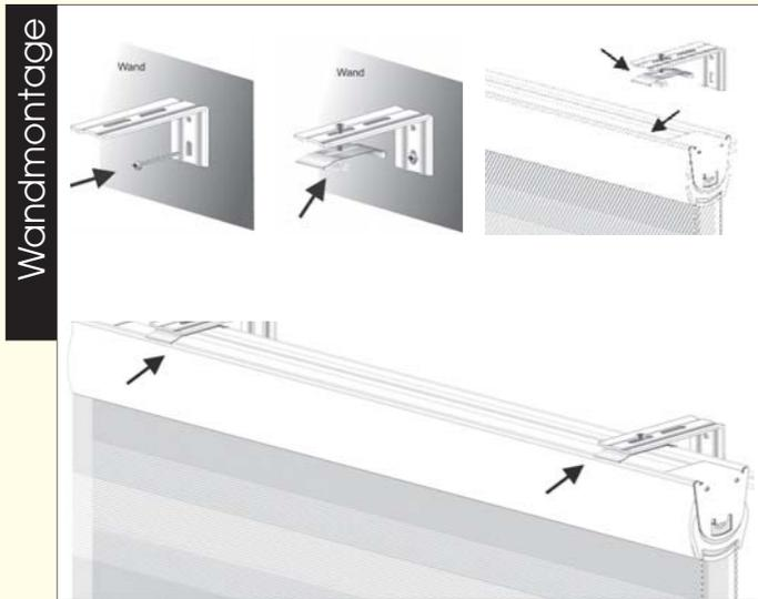
Die Wandträger werden mithilfe der im Lieferumfang enthaltenen Dübel an der Wand befestigt. Danach werden die Clips an den Wandträgern befestigt und das Duo-Rollo mit dem Profil in die Clipse eingerastet.
